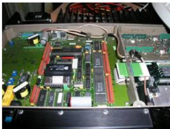
L'avantage par rapport aux méthodes employées par différents Om's, c'est qu'il n'est pas nécessaire de fabriquer la platine construite autour d'un PIC 16F84 et que la platine CPU est totalement réutilisée dans sa version d'origine sauf pour quelques octets de la mémoire
