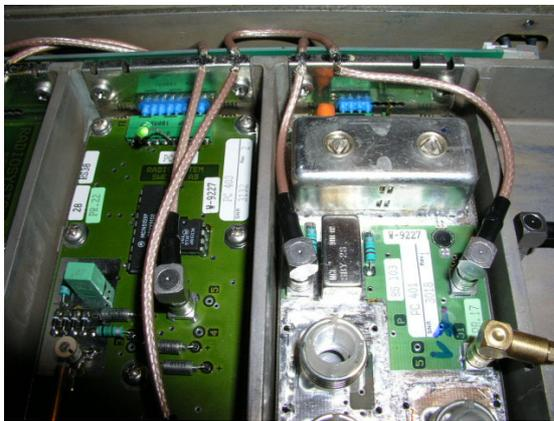
Il a fallut aussi ajouter un fil étamé de 10/10 dans le prolongement de la cloison centrale du capot pour diminuer le couplage comme indiqué dans le document de F1COW. Pour les filtres d'entrée, j'ai suivi les recommandations de F1COW et j'ai dû aller un peu plus loin dans les découpes des selfs pour monter jusqu'à 439,400 MHz.
