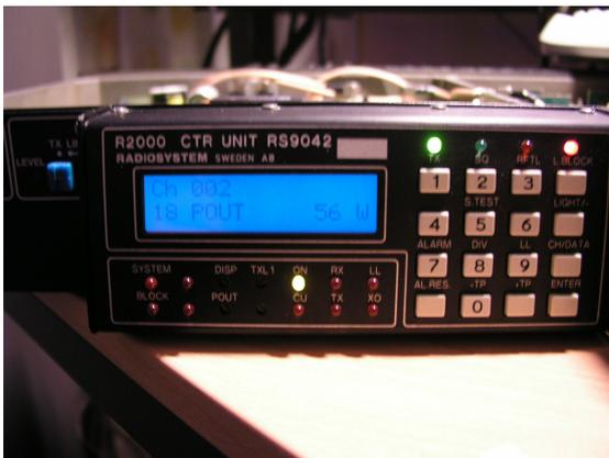
Pour la partie émission, je n'ai pas fait grand chose car j'utilise les fréquences très proches de celles normalement utilisées par la configuration usine. Le VCO TX n'a subi aucune modification, comme le PA DRIVER que j'ai démonté et ouvert pour rien! Je n'ai même pas repris les réglages du PA final. J'obtiens 50W sur 430,025 MHz sans aucun problème.
