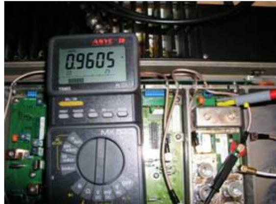
J'ai procédé par étape pour réduire la self et placer le capot en ajustant les vis pour trouver le meilleur réglage.
