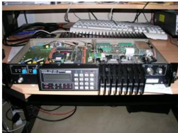
Le RS9042 est normalement prévu pour fonctionner sur la bande 414-418Mhz et 424-428 Mhz en full duplex. L'émission est en haut de bande (424-428 MHz) ; ce qui est intéressant pour un relais radioamateur fonctionnant en bas de bande UHF vers 430 Mhz.
